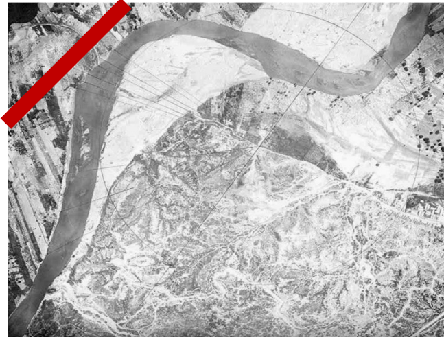
Fig. 6 La migración del meandro amenaza la estabilidad de un camino próximo
